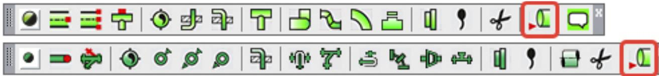
Questo comando permette di calcolare i diversi livelli di una rete a gravità. Designando alcuni punti strategici, il sistema di controllo calcola il nuovo flusso d'acqua secondo le sezioni.
